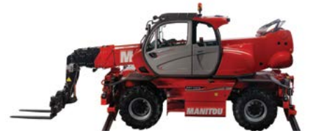
Rotazione su stabilizzatori estesi con braccetto 1500 kg EN 1459
