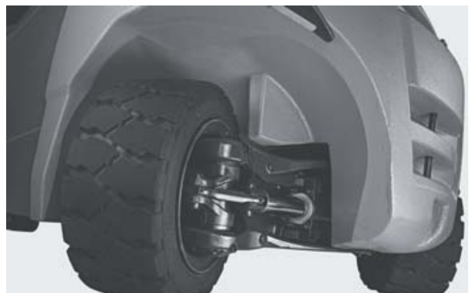
À la fois maniable et stable grâce au palier articulé haut
