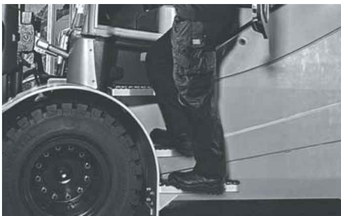
Sécurisation des montées à bord et descentes par des marchepieds antidérapants visibles depuis le haut
