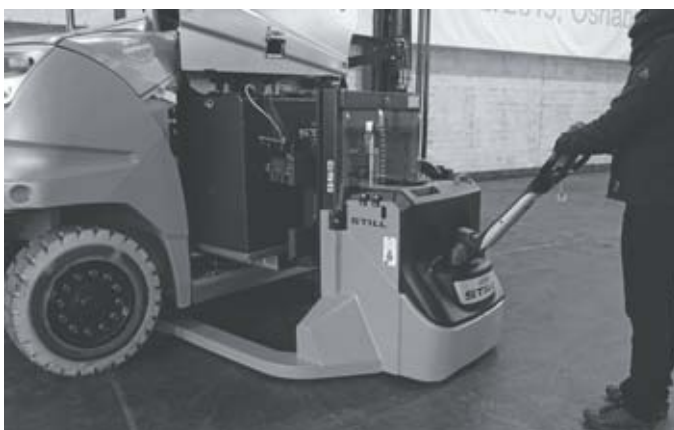
Changement de batterie rapide avec le gerbeur ECU 30
