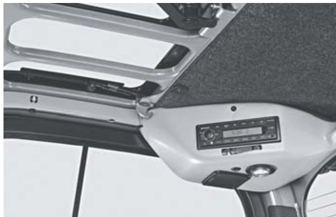
Double interface de communication : radio avec prise USB et dispositif mains libres Bluetooth
