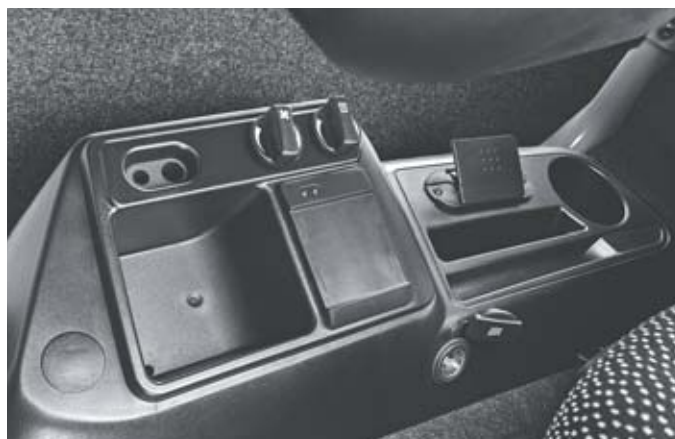
Rangements de bord et prise 12 V – par ex. pour charger un téléphone portable
