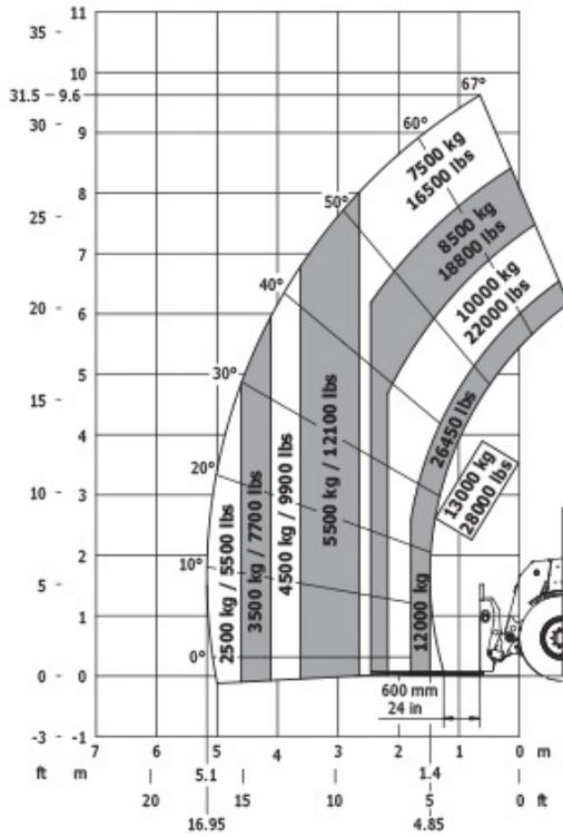
Machine sur pneus avec pendulaire Métric
