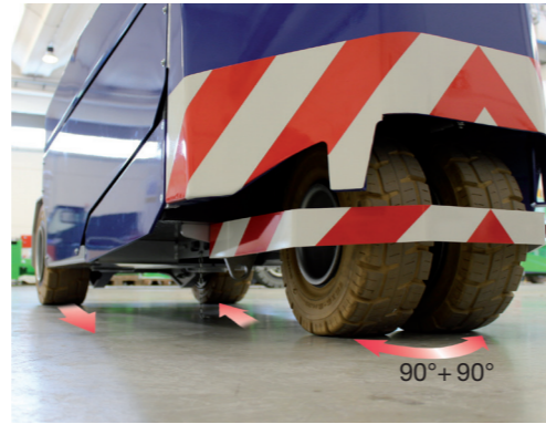
CONTRE ROTATION SUR LES ROUES AVANTES ET DIRECTION DES ROUES 90°+90°
