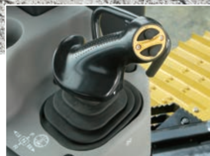
Système ergonomique PCCS (Palm Command Control System)
