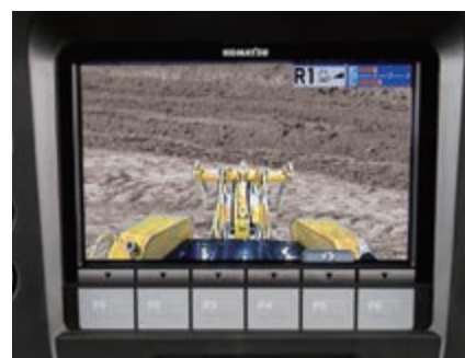
Système de caméra vue arrière complètement intégré
